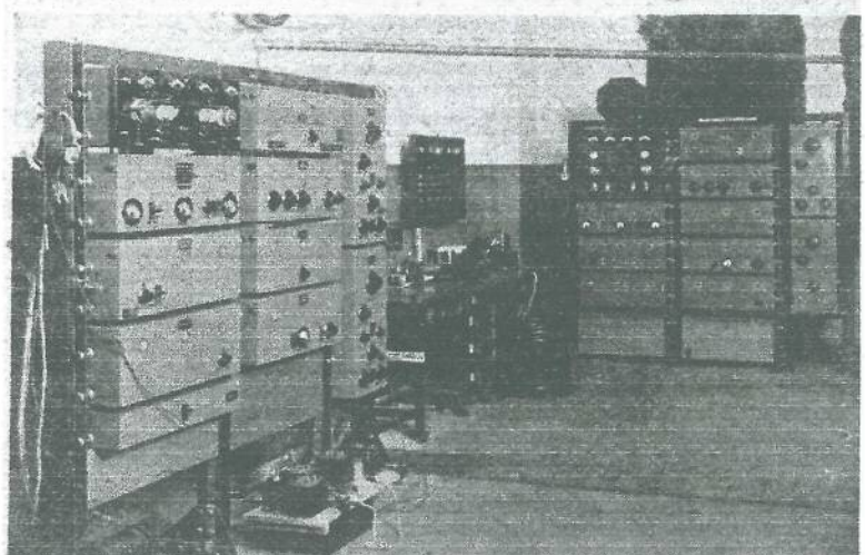
第 1・60 圖 マルコニ会社製短波電信受信機 RC-24L 型（正面）と RC-24V 型（左側）
